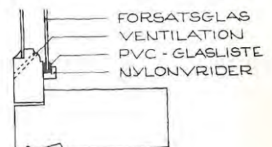
VINDUE MED FORSATSGLAS PÅ VINDUESRAMMERNE
